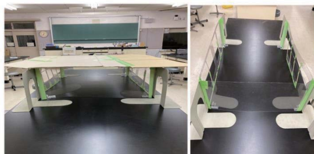
図1:10分の1教室模型, 壁はアクリル板, 天井は段ボール紙で再現した(70×90×30[cm]=189000[cm 3 ])
