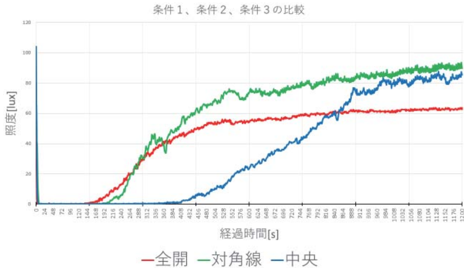
図6：換気時間と照度の関係(補正なし)
