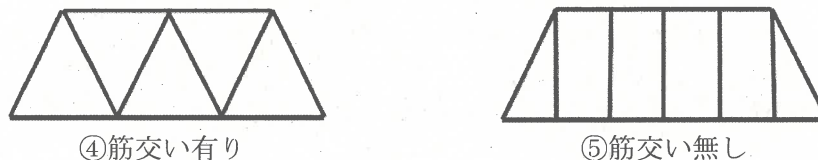
図3：筋交いの有無によるパスタ橋の構造
